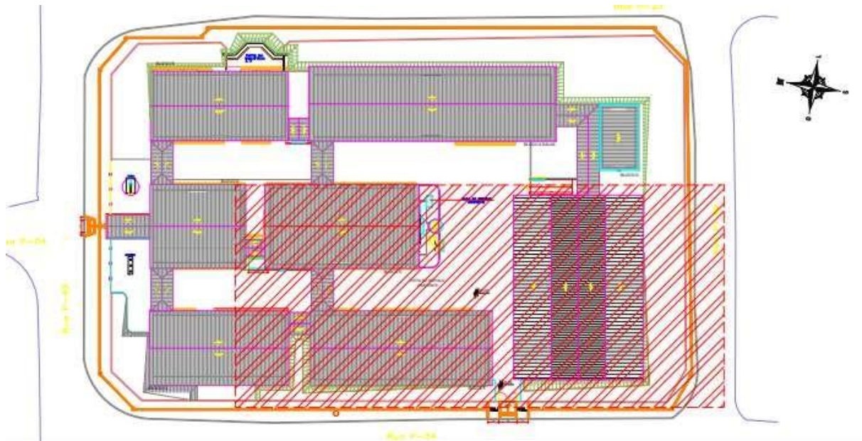
FIGURA 3 – ÁREA SUGERIDA PARA INSTALAÇÃO DO SISTEMA FV.
