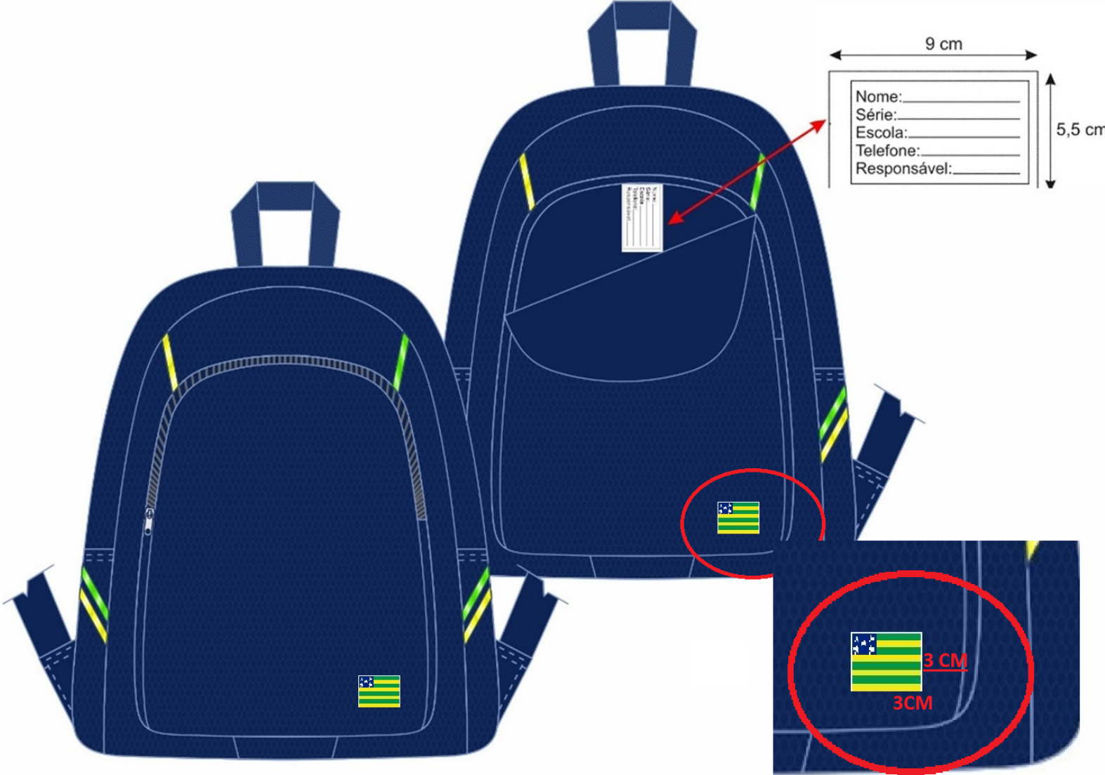
Fig: fixação da etiqueta de identificação
