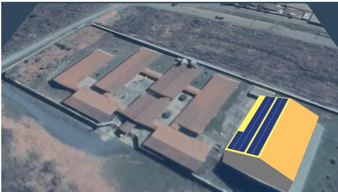
FIGURA 2 – ÁREA SUGERIDA PARA INSTALAÇÃO DO SISTEMA FV.
